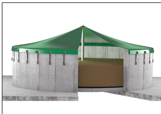
Figura. Tanque de hormigón de almacenamiento de digestato.
